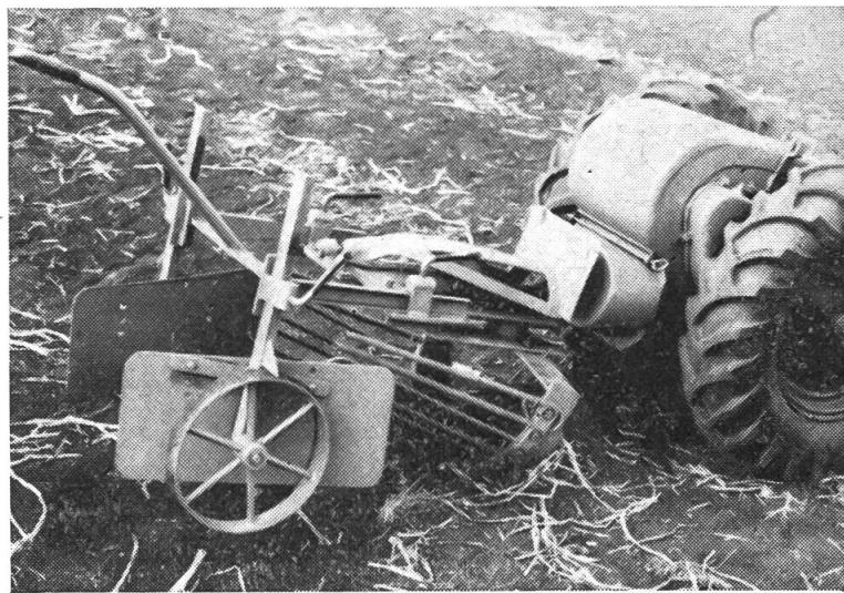
links: Schüttelrost Bur leistet in Witzwil gute Arbeit. Auf diesem Bild 2reihig am Traktor ....
