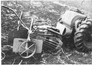
links: Schüttelrost Bur leistet in Witzwil gute Arbeit. Auf diesem Bild 2reihig am Traktor .... rechts: .... und hier einreihig an der Einachsmaschine.
