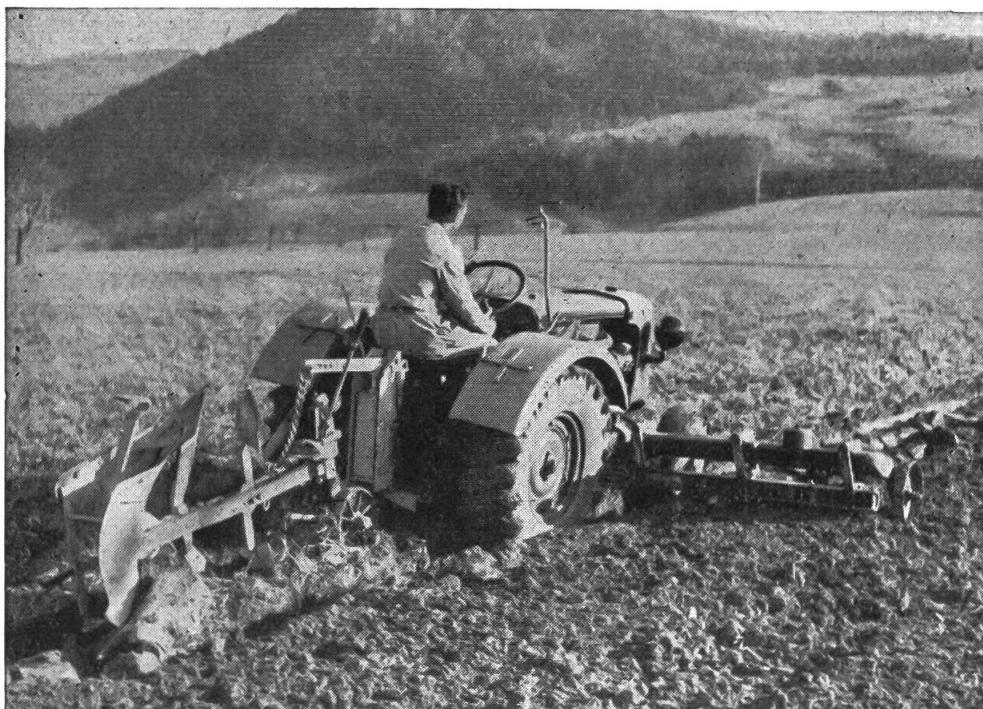
**Ott-Anbaupflüge** mit Stützrädern leisten in der Ebene und am Hang beste Arbeit. Sie sind während der Arbeit weitgehend unabhängig von den Bewegungen des Traktors und in der Arbeitsleistung deshalb den Selbthalterpflügen am ähnlichsten. Verlangen Sie unverbindliche Offerten für Anbaupflüge und Anbaukultivatoren.
