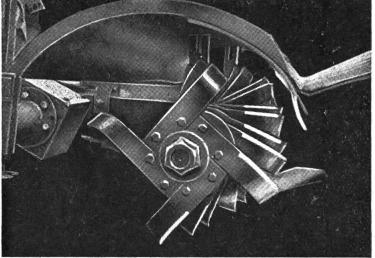
Fräsewelle mit abgekröpften Messern und automatischer Ausschaltkupplung.
