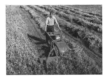
Abb. 5: Bucher-Motormäher K 3 mit Eingrasvorrichtung und Spezialbalken.
