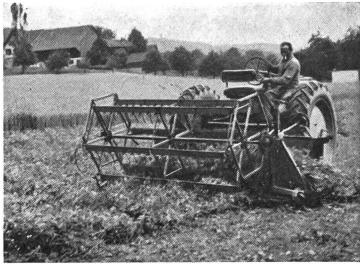
Abb. 1: Mulchbalken mit Trennscheibe und Weglegevorrichtung.
