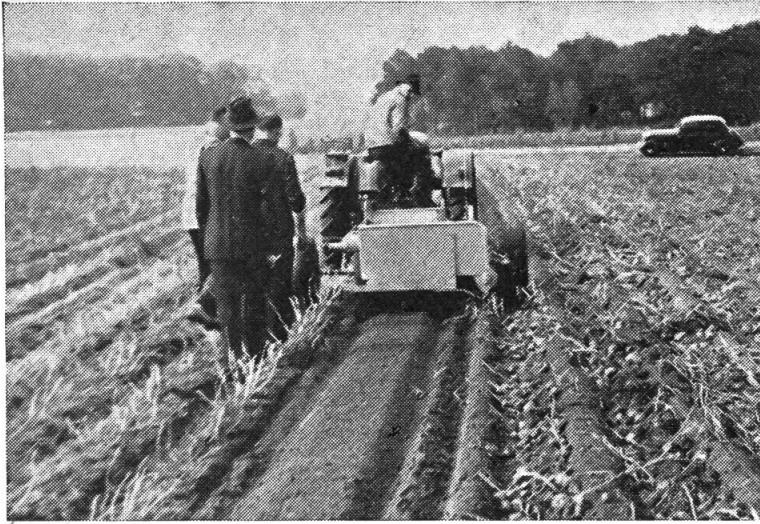
Abb. 3: Siebband-Vorratsroder «Wisent» bei der Arbeit. Hersteller: Hagedorn & Co., Warendorf/Westf.
