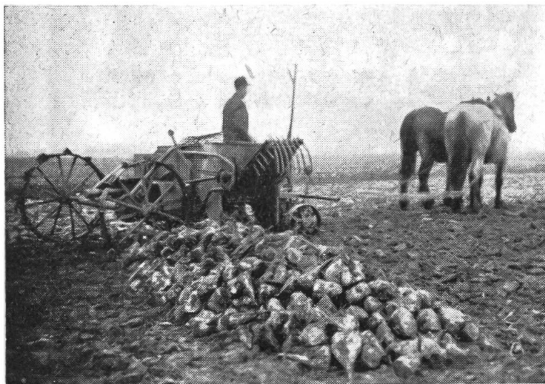
Abb. 11: Rübenerntemaschine «Rübenhamster», einreihig, für Gespann- oder Traktorzug. Hersteller: Maschinenfabrik Hagedorn, Wenningsen/Hann.
