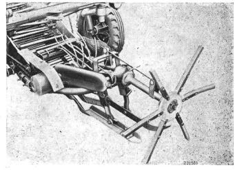
Abb. 13: Rübenvollerntemaschine Stoll, einreihig. Sammelt Blatt und Rüben getrennt und legt sie im Querschwad ab.
