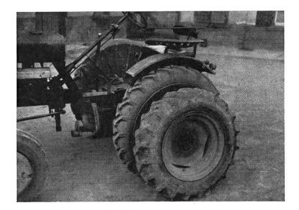
Abb. 6: Zwei Reifengrössen für den gleichen Traktor (12 PS). Vorn 8-20, hinten 7-36. Der höhere, schmalere Reifen hat eine um 25 % höhere Zugleistung.
