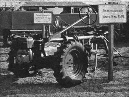
Abb. 16: Der neue Lubeck-Trak, 7,5 PS. Er wird im Gegensatz zu andern Einachsern vom Fahrsitz aus mit Handrad gesteuert.
