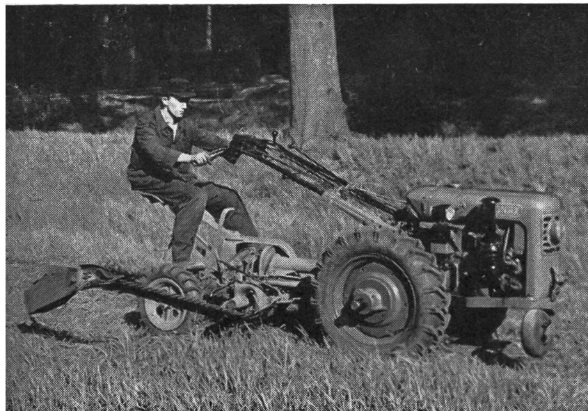
Abb. 17: Monax-Geräteträger mit angebauter Mähmaschine für Zapfwellenantrieb.
