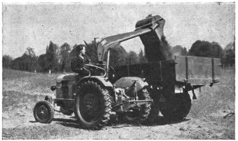
Abb. 1: Der neue BTG-Allrad-Diesel-Traktor 4/25 mit 24 PS 2-Zylinder Dieselmotor.
