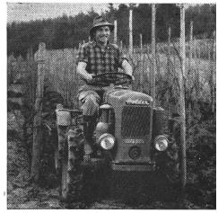
Abb. 5: Der Hanomag R 12 mit Anbau-Sämaschine.
