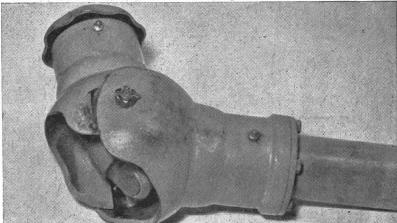
Abb. 8: Schnellverschluss mit Sperr-Ring.
