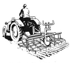
Doppeltwirkende Anbauegge, durch Steuerträger belastet und unbelastet arbeitend. Nutzbare Arbeitsbreite 2.20 m
