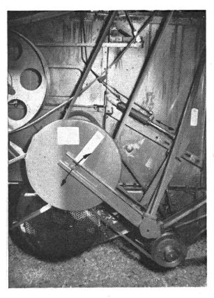
Hydraulisch gesteuerter Variator an einem selbstfahrenden Mähdrescher der Firma Claas.
