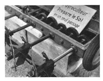
13 Fräse mit senkrecht zur Fahrtrichtung liegenden Rotationsachsen.
