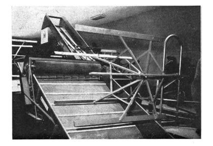
Feldhäcksler mit einem Schneidaggregat bestehend aus Wassertrommel und Gummiwalze (I.H.C.).
