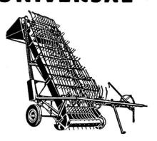
für Zapfwellen- oder Bodenantrieb, mit Verlängerungselevator; ladet direkt hinter dem Traktor.
