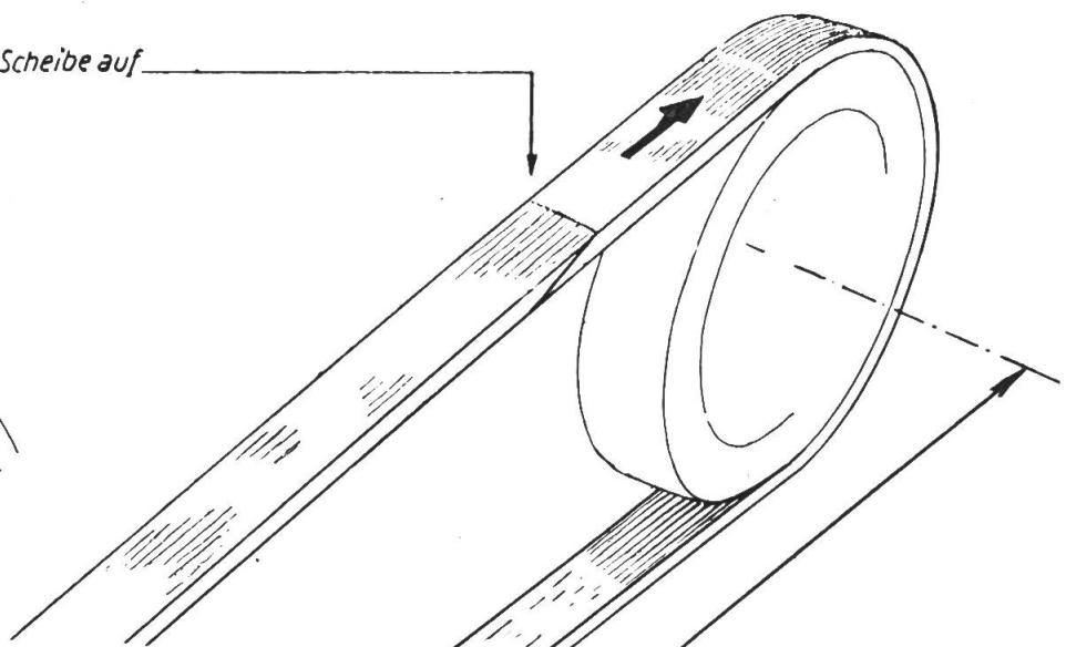
Die beste Verbindung der einzelnen Riemenstücke erfolgt durch Leimen.
