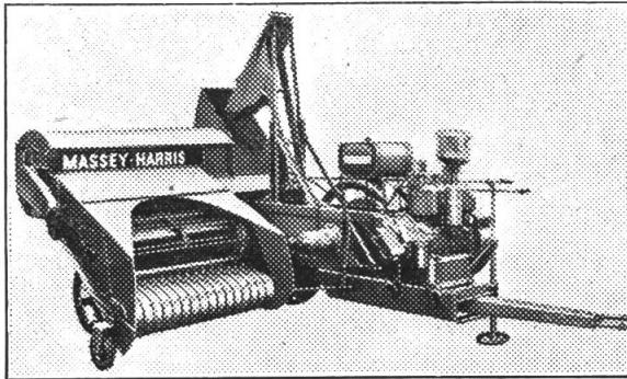
No. 701 HARTBALLEN-PRESSE «PICK-UP» **MASSEY-HARRIS**, für Traktorzug mit Aufbaumotor 31-39 PS oder Zapfwellenantrieb. «Pick-up»-Arbeitsbreite 1,50 m. Doppelte Sisal-Knüpfer. Ballengrösse 35 x 45 x 90 cm. Arbeitsleistung min. 3 Ballen pro Minute, je nach Erntegut.
