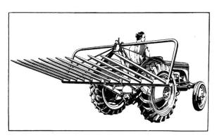
**GRASLADE-RECHEN,** speziell geeignet zum Einbringen des Silogutes. 3-Punkt-Aufhängung mit Ausklinkvorrichtung zum Entladen. Arbeitsbreite 2,5 m, Rahmenhöhe 77,5 cm, 12 Zähne zu 1,2 m Länge.
