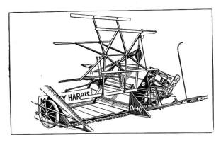
No. 830 **BINDEMÄHER MASSEY-HARRIS** für Traktor und Tierzug durch Zapfwellenoder Radantrieb. Einfachstes Umstellen jederzeit möglich. Robuste Konstruktion. Bewegliche Teile auf Rollen- oder Kugellagern laufend. Arbeitsbreite 1,5 und 1,8 m.
