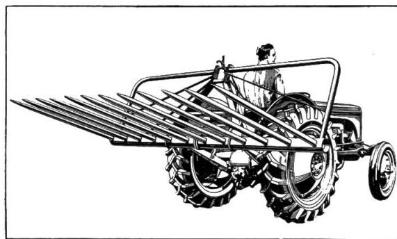
**GRASLADE-RECHEN**, speziell geeignet zum Einbringen des Silogutes. 3-Punkt-Aufhängung mit Ausklinkvorrichtung zum Entladen. Arbeitsbreite 2,5 m, Rahmenhöhe 77,5 cm, 12 Zähne zu 1,2 m Länge.
