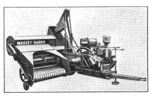
No. 701 HARTBALLEN-PRESSE «PICK-UP» MASSEY-HARRIS, für Traktorzug mit Aufbaumotor 31-39 PS oder Zapfwellenantrieb. «Pick-up»-Arbeitsbreite 1,50 m. Doppelte Sisal-Knüpfer. Ballengrösse 35 x 45 x 90 cm. Arbeitsleistung min. 3 Ballen pro Minute, je nach Erntegut.
