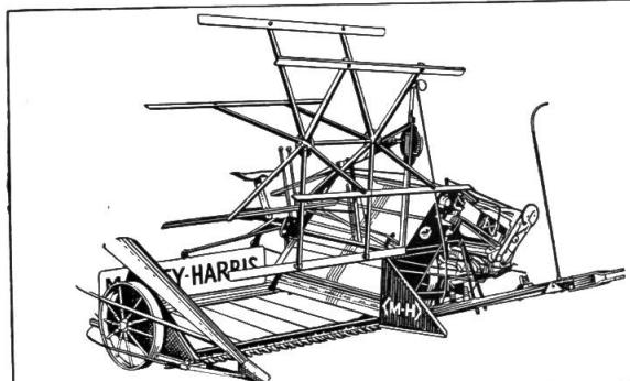
No. 830 **BINDEMÄHER MASSEY-HARRIS** für Traktor und Tierzug durch Zapfwellen- oder Radantrieb. Einfachstes Umstellen jederzeit möglich. Robuste Konstruktion. Bewegliche Teile auf Rollen- oder Kugellagern laufend. Arbeitsbreite 1,5 und 1,8 m.
