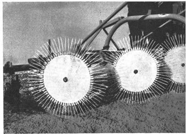
Links: Hack- und Jätegerät «System Rémy», bürstet und durchkämmt den Boden und entfernt keimendes Unkraut in den Reihen und zwischen den Reihen auf der ganzen Fläche. Arbeitsbreite mit 9 Scheiben 1,80 m.
