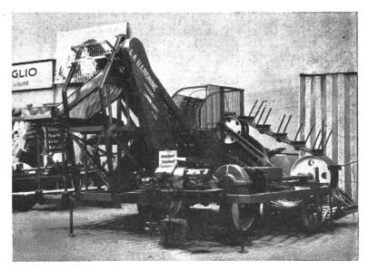
Links: Sackheber am Wagen, mit Benzinmotor, kann auch mit Handkurbel betätigt werden.
