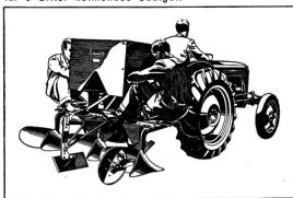
Querhackgerät zum Auslichten von Zuckerrübenkulturen, 4- und 6-reihig. Einzel abgefederte Auslichträder mit auswechse!baren Messern.
