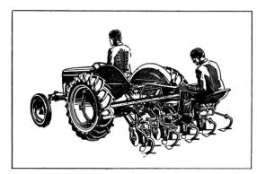
Hackgerät, steuerbar, leicht verstellbare Löffel- und Gänsefußscharen und Scheiben, Bedienung mit Feinsteuermann. 4-reihig (speziell für Zuckerrübenbau).
