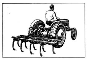
Kultivator Tiller, 9 an Spiralfedern aufgehängte Zinken für Arbeit auch in schwersten Böden. Auswechselbare Scharen. Arbeitsbreite 1,86 m, Arbeitstiefe 23 cm.
