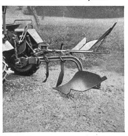
3- oder 4-Punkt-Aufhängung, 2 und 3 Schar-Einsätze, einfache Konstruktion. Bewährt in schwierigem Hanggelände. Bruchsicherung. An den Heber passende Geräte: Kultivator, Egge, Spurlockerer, Vielfachgerät. Alle Geräte in weniger als 1 Minute an- und abmontiert.
