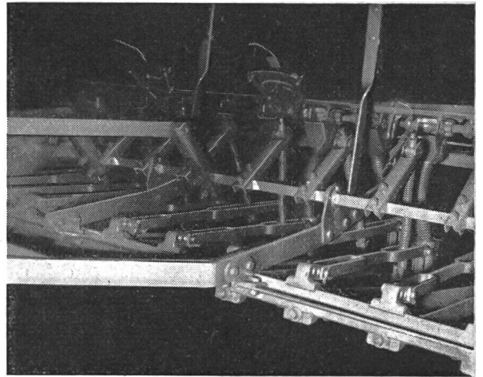
Abb. 1: Die neue «Fendt»-Hydraulik mit 3-Punkt-Aufhängung. Dahinter Melotte-Tellerdüngerstreuer. X. Fendt, Marktoberdorf/Allgäu. Melotte S.A., Gembloux/Belgien.
