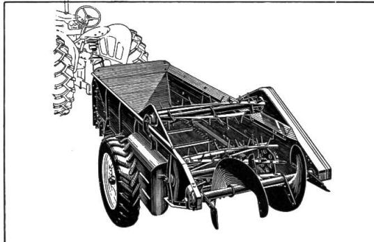
**Mistzettler**: Radantrieb, neuer Streumechanismus, Nutzinhalt 2 m<sup>3</sup>.
