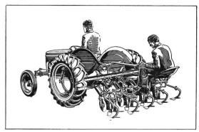
Hackgerät, steuerbar, leicht verstellbare Löffe!- und Gänsefußscharen und Scheiben, Bedienung mit Feinsteuermann. 4-reihig (speziell für Zuckerrübenbau).
