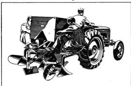
Hackgerät S.K.E., 9 federnde, leicht verstellbare Zinken mit 1 Steuerschare für 3-reihige Hackarbeiten in Reihenkulturen (Kartoffeln, Zuckerrüben etc.)
