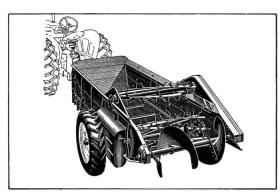
$\begin{array}{lll} \textbf{Mistzetter:} & \text{Radantrieb, neuer Streumechanismus,} \\ \text{Nutzinhalt 2} & m^3. \end{array}$
