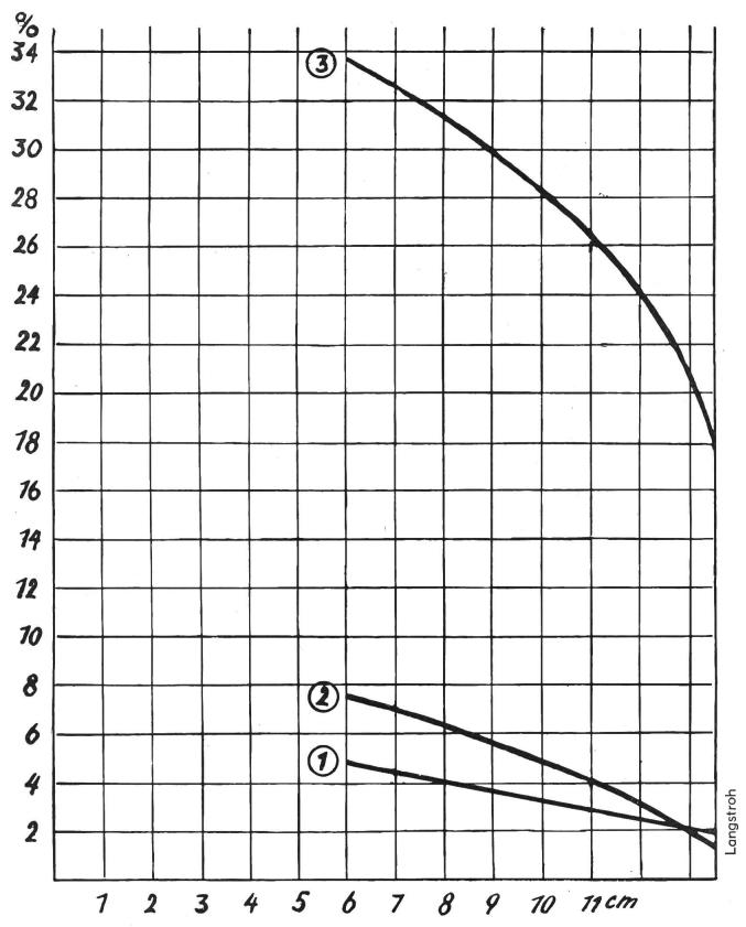
Abb. 4: Körnerbruch bei normaler Dreschmaschine und beim Häckseldruschverfahren. 1 = Weizen 2 = Roggen 3 = Korn
