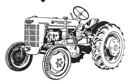
Die neuen **Diesel-Allzwecktraktoren DED und DGD** sind wendig auf dem Acker und schnell auf der Strasse. Das IH-Fünfgang-Präzisions-Getriebe bewirkt eine fast verlustlose Uebertragung der Leistung auf die Hinterräder, daher die erstaunlich hohe Zugkraft.
