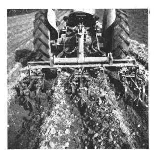
Das Vielfachgerät «Kombi» beim Hacken mit Steuervorrichtung.
