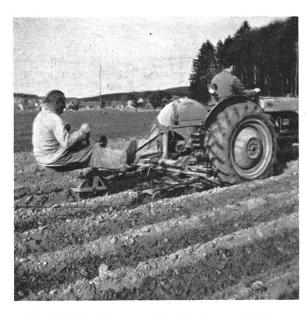
Das Vielfachgerät «Kombi» beim Hacken ohne Steuervorrichtung.
