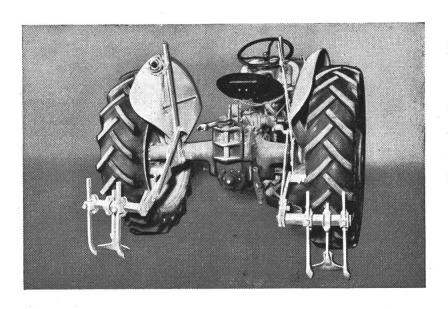
Die Verwendung von Spurlockerern ist beim Ueberfahren des gepflügten Ackers mit Traktoren und gezogenen oder angebauten Eggen, Sämaschinen, Walzen, usw. unerlässlich. Bis vor kurzem wurden die Spurlockerer in der Regel mit einem Verlängerungsstab an der Ackerschiene des
