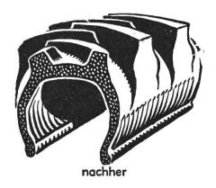
Beschreibung: Beim Traktorenpneu «Vacu-Lug» handelt es sich um einen abgenützen Pneu mit noch gutem Unterbau und aufvulkanisierten Stollen. Bei der Aufgummierung wird das ursprüngliche Pneuprofil in der Regel nachgeahmt. Die aufgummierten Pneus weisen gegenüber den neuen etwas höhere und breitere Profilstollen auf.
