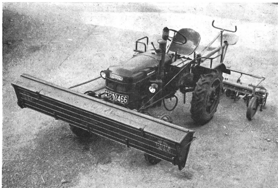
Traktor mit Frontdüngerstreuer (Fabrikat Rau) und Anbaukultivator (Werkphoto)
