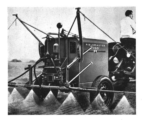
Die neue «Fieldmaster-Spritze 150» als Anhängegerät. Sie spritzt 70—1200 lt. je ha. Der Tank fasst 680 lt. 7,3 m Arbeitsbreite. Antrieb durch Zapfwelle.
