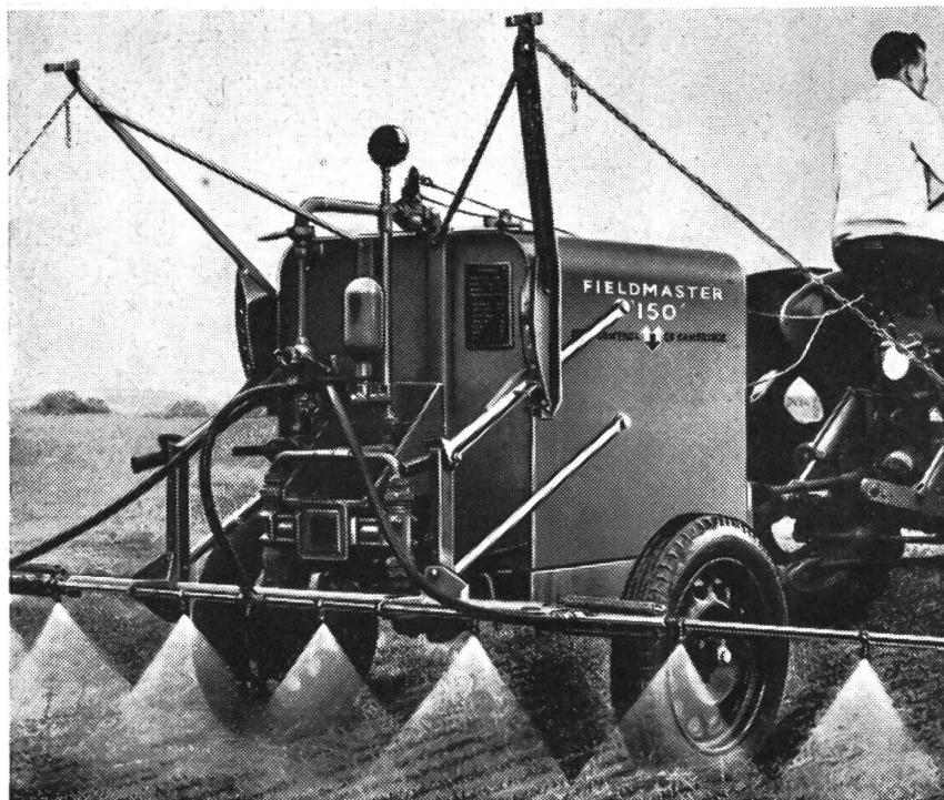
Die neue «Fieldmaster-Spritze 150» als Anhängergerät. Sie spritzt 70—1200 lt. je ha. Der Tank fasst 680 lt. 7,3 m Arbeitsbreite. Antrieb durch Zapfwelle.
