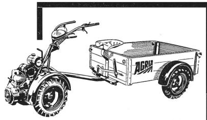
AGRIA-Universal 5 PS 200 cm³ mit Anhänger als Transportfahrzeug, Nutzlast 400 kg, Geschwindigkeit 20 km/Std.
