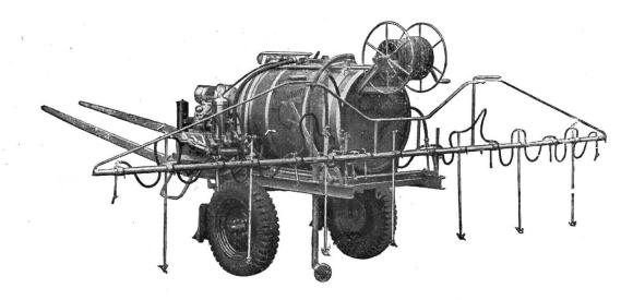
Abb. 8: Pferdegezogene Motorspritze mit Querbalken und 22 verstellbaren Düsen.
