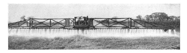
Abb. 9: Selbstfahrende Motorspritze mit Querbalken und 100 Düsen (18 m Arbeitsbreite!).
