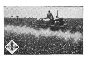
Abb. 7: Motorspritze mit Querbalken auf Traktor (38 Düsen)
