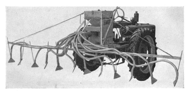
Abb. 10: Motorzerstäuber mit Querbalken auf Traktor.
