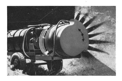
Abb. 15: Verteilapparat für Obstbau (drehbar), kann auch doppelseitig ausgeführt werden.
