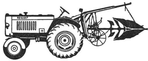
Wir fabrizieren die normale **Dreipunkt-Aufhängung** für Zapfwellen-Antrieb, mechanisch oder hydraulisch. — **Automatische Pflughebe- und Wende-Vorrichtung (+** Patent) für alle normalen Traktoren. Ihr Selbsthalterpflug wird zum Anbaupflug.
