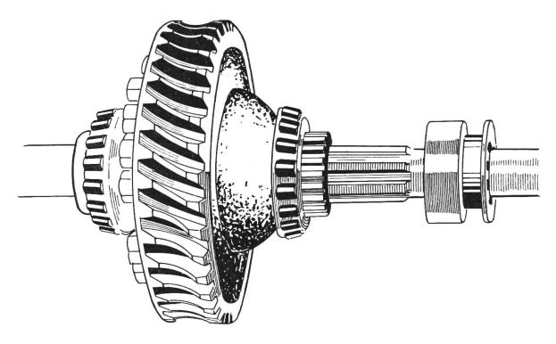
Fig. 170: Differentialgetriebe mit Sperre eines Hürlimann-Traktors. Die Kegelräder des Differentials sind im Schneckenradinnern eingebaut. Die Sperre kuppelt das Differentialgehäuse mit der einen Achshälfte.
