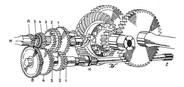
Fig. 164: 5-Gang-Traktorengetriebe (Bührer «Standard»). Die Welle M wird vom Motor angetrieben und treibt über die Räder A und B die Vorgelegewelle. Die Räder 1—4 können durch Verschieben mit den entsprechenden Rädern auf der Vorgelegewelle zum Eingriff gebracht werden. Das Rad 4 kann durch die Nuten 5 direkt mit dem Rad A zum Eingriff gebracht werden (direkter Gang). Durch die Kupplung K wird die Zapfwelle eingeschaltet.
