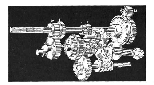
Fig. 166: Motormähergetriebe mit 3 Vorwärts-, 1 Rückwärtsgang und Messerantrieb (Bucher Rekord). 1—3 = Räder für die entsprechenden Gänge.
