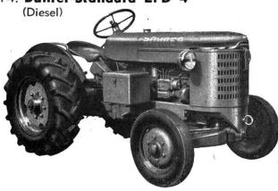
Gewicht ohne Zusatzgewichte: mit Stahlrädern 1600 kg; mit Gussrädern 1800 kg.
