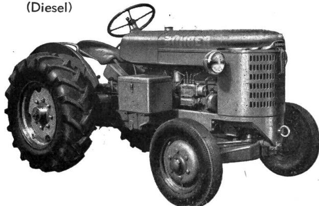
**Gewicht** ohne Zusatzgewichte: mit Stahlrädern 1600 kg; mit Gussräder 1800 kg.
