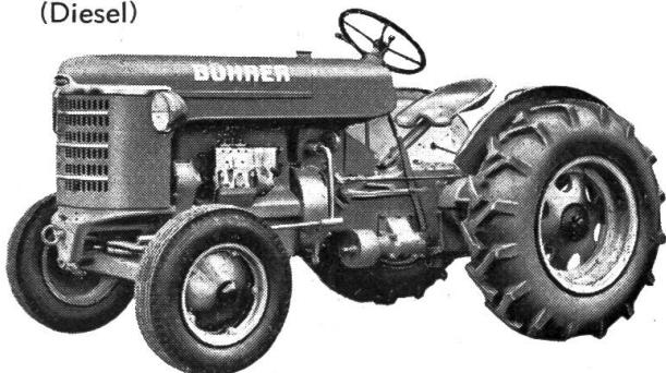
**Gewicht** ohne Zusatzgewichte: mit Stahlrädern 1750 kg; mit Gussräder 1950 kg.
