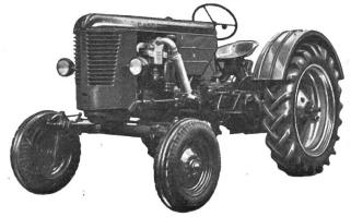
mit gleichem Motor, mit ausziehbarer Vorderachse 1200-1700 mm oder 1300-1900 mm hintere Spurweite verstellbar 1320-2200 mm, Bereifung 9-34.
