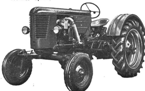
mit gleichem Motor, mit ausziehbarer Vorderachse 1200-1700 mm oder 1300-1900 mm hintere Spurweite verstellbar 1320-2200 mm, Bereifung 9-34.
