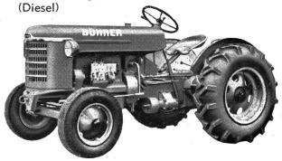
Gewicht ohne Zusatzgewichte: mit Stahlrädern 1750 kg; mit Gussrädern 1950 kg.
