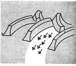
Bewegliche Profil-Kanäle. Zur Verhinderung des Erdstaus und zur Erleichterung des Erdabflusses.
