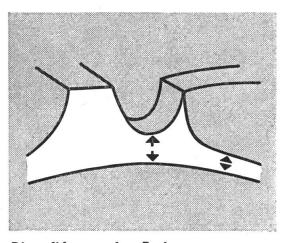
Die solid verstrebte Basis verhindert das übermässige Durchbiegen der Stollen. Das Aufprallen der Stollen-Enden wird dadurch ausgeschaltet.
