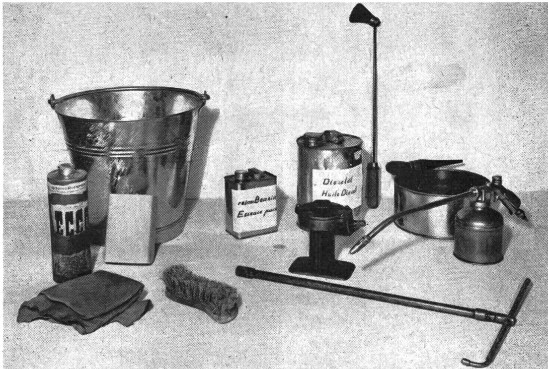
Abb. 2: Reinigungssatz: Kanne Dieselöl Wagenheber Kanne mit Reinbenzin und mit Schaummittel Zerstäuber, wenn Pressluft 2 Twist. Kessel mit Schwamm und Hirschleder Pinzel, Rundbürste 2 kleine Büchsen
