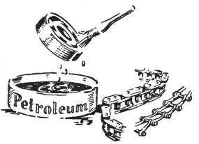
Abb. 7: Entfernen von Oel, Staub usw.
