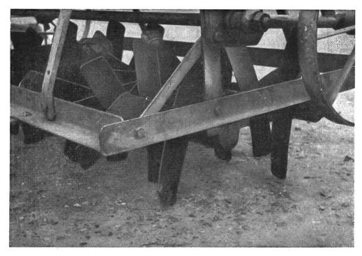
Abb. 14: Spatenegge mit nachgeschmiedeten, genügend langen Spaten.
