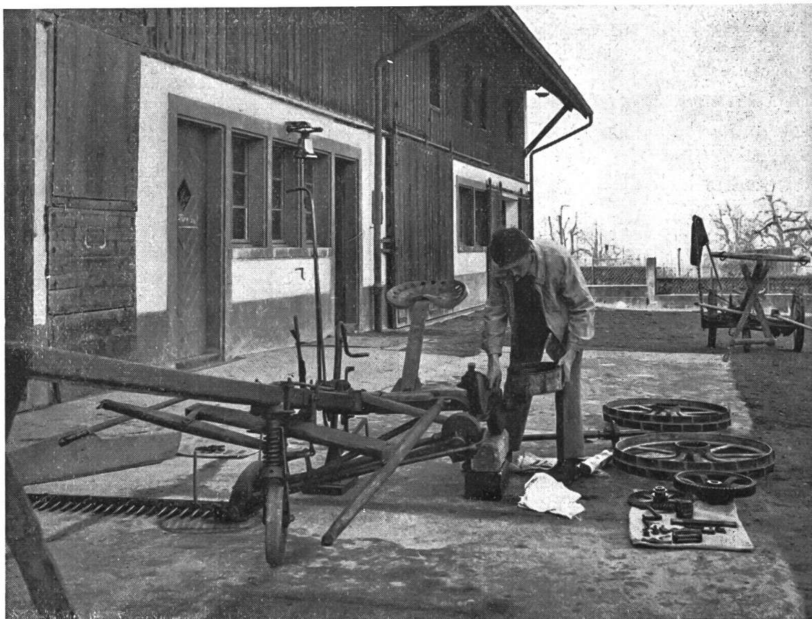
Abb. 11a: Gründliche Revision und Reinigung einer Mähmaschine
