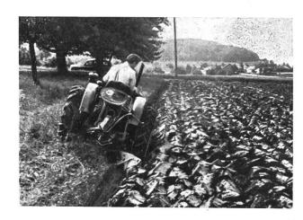
... leistet aber dank seinem **Kippsystem** und seinen zahlreichen Gängen eine erstaunliche **Pflug- und Zugarbeit.** — **Automatisches Heben der Anbaugeräte** (Pflug, Vielfachgerät, Ackerfräse usw.) durch das Kippsystem des Traktors (ohne Hydraulik).
