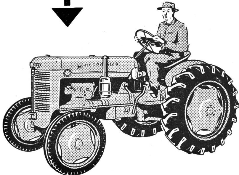
Die neuen *Diesel-Allzwecktraktoren DED und DGD* sind wendig auf dem Acker und schnell auf der Strasse. Das IH-Fünfgang-Präzisions-Getriebe bewirkt eine fast verlustlose Übertragung der Leistung auf die Hinterräder, daher die erstaunlich hohe Zugkraft.
