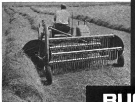
Rotorrechen für Frontmontage oder als gezogene Maschine
