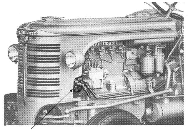
Oeldruckpumpe für Hydraulik
