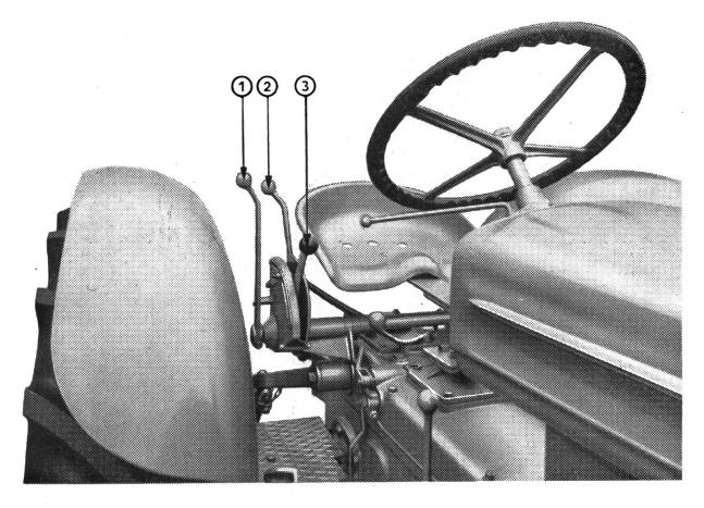
Die Bedienungshebel für die Hydraulik. Hebel 1 dient zum Einschalten des Mäh- oder Motoreggenantriebes. Hebel 2 erlaubt die Bedienung der unabhängigen Seitenhydraulik für Mähapparat oder Motoregge. Beim hydraulischen Hochziehen des Mähapparates oder der Motoregge wird deren Antrieb automatisch ausgeschaltet. Hebel 1 wird also nur zum Einschalten benötigt. Mit Hebel 3 bedient man die automatische Vorwähl-Hydraulik für die an der Dreipunktaufhängung montierten Geräte.
