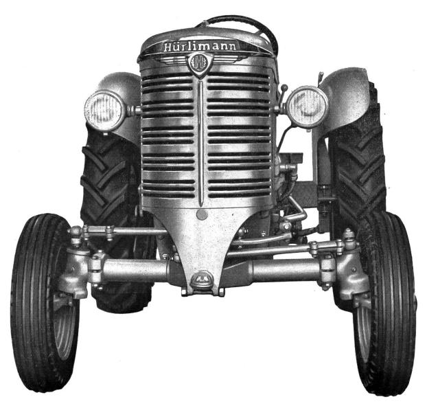
Ansicht von vorne. Teleskopvorderachse gelagert auf Achsträger aus Stahlguss. Achse und Spürstange sind ausziehbar und ermöglichen die Verstellung der Spürweite. Neue Konstruktion der Radgelenke am Achsschenkel.
