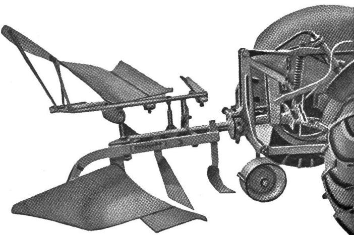
Die **ERISMANN** Anbaupflüge, **Wendepflug** und **Winkeldrehpflug** mit sofortigem Tiefgang, für die Traktoren mit hydraulischem Kraftheber, haben sich glänzend bewährt.
