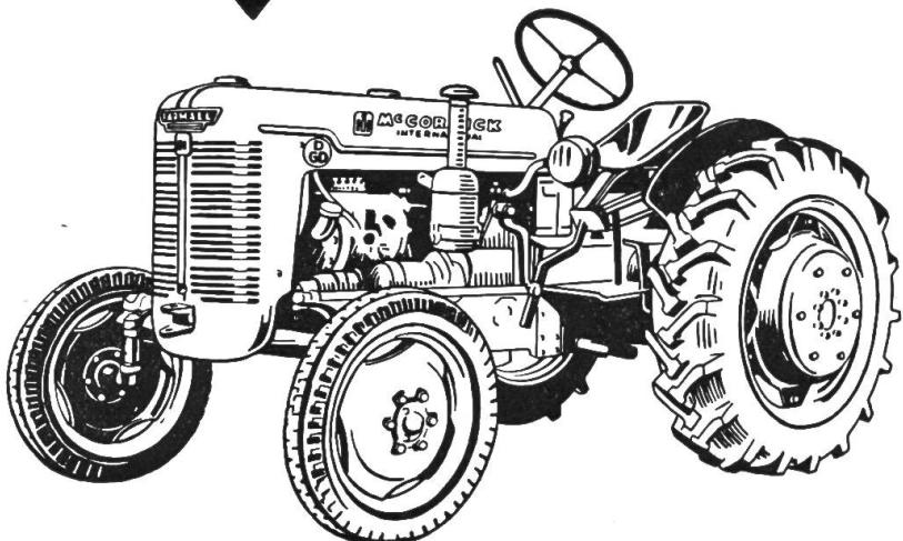
Die neuen *Diesel-Allzwecktraktoren DED und DGD* sind wendig auf dem Acker und schnell auf der Strasse. Das IH-Fünfgang-Präzisions-Getriebe bewirkt eine fast verlustlose Übertragung der Leistung auf die Hinterräder, daher die erstaunlich hohe Zugkraft.
