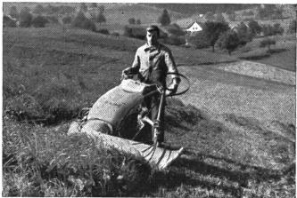
Links: A Mähen mit dem Klein- und Bergmäher Rapid-Rex an einem Steilhang.
