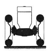
Tieflage zum Mähen am Steilhang Breite Spur
