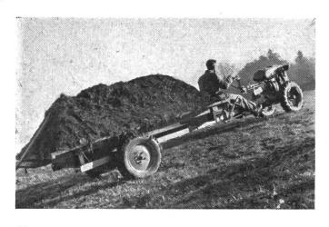
Einachstraktor S-Super mit Zapfwellenanhänger.
