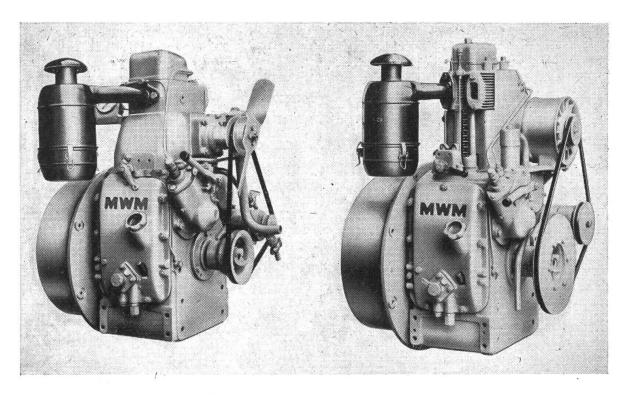
Der wassergekühlte und luftgekühlte Dieselmotor der Motoren-Werke Mannheim. Leistung 12 PS bei 2000 U/min.
