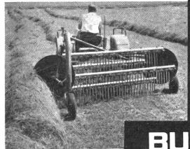
Rotorrechen für Frontmontage oder als gezogene Maschine
