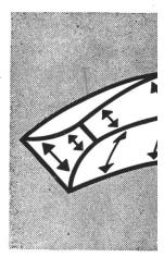
Die Profilstollen sind konisch. Sie fassen das Erdreich tiefer in dasselbe ein Zugkraft.
