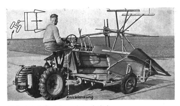
**Abb. 7:** Im Institut des Verfassers gebauter «Autobinder».
