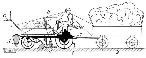
Abb. 2: Geräteträger mit Gerätekette.
