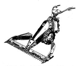
AGRIA, Typ 1300, 5 PS, 200 cm³, Spezialmotormäher, Fr. 1590.—, komplett mit Gummirädern.
