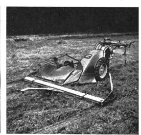
Abb. 1: Hinter einem Motormäher angehängter Graswagen.
