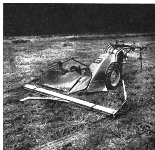
Abb. 3: Motormäher mit am Mähbalken eingehängter Deichsel.
