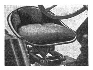
Abb. 2: Der sog, Wannenschwingsitz mit verstellbarer Federung, hydraulisch gedämpft und Schaumgummisitzkissen, vermeidet gesundheitsschädliche Erschütterungen.
