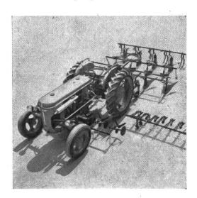
Links: Pflügen, Eggen, Untergrund-Lockern und Säen in einem Arbeitsgang.
