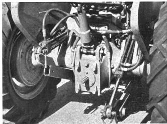
Links und Rechts: Dreipunktbefestigung. Zu beachten ist, ausser der Hangeinstellung durch Schraube und Handrad, der Umstellhebel für die symmetrisch entgegengesetzte Stellung.
