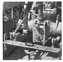
Links: Sichtbar sind: die Steuerhebel der beiden hydraulischen Lifte, der Gang-Schalthebel, der Schalthebel des 10-Gang-Zwischengetriebes mit Kriechgang, der Schalthebel für zwei verschiedene Drehzahlen von Zapfwelle und Keilriemenantrieb, die Fuss- und Handgassteuerungen (man beachte die beiden Markierungen, die einer Drehzahl von 540 U/min. an der Zapfwelle entsprechen), das Bremspedal sowie die Flanschen zur Befestigung der Geräte und der hydraulischen Lifte.
