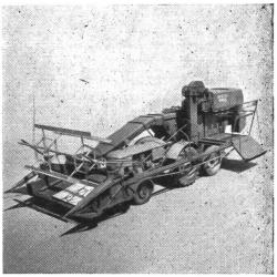
Links: Mähdrescher Wintenberger, in eine Pick-up-Presse verwandelt. Der Mähbalken ist durch den Aufnehmerbalken, und die Dreschvorrichtung durch die Presse ersetzt.
