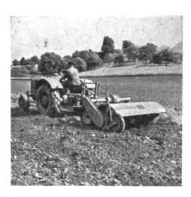
Links: Fräsen mit Rotavator, Arbeitsbreite 135 cm, Arbeitstiefe bis zu 20 cm.
