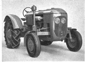
Links: Der Vevey 583 (Diesel) oder 585 (Petrol), ausgerüstet mit schmalen und hohen Rädern,
