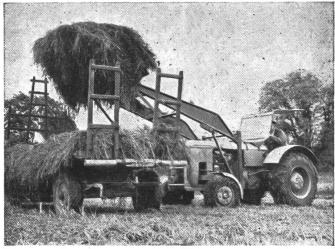
Links: Aufladen von Stallmist mit Frontlader. Rechts: Aufladen von Heu mit Frontlader.
