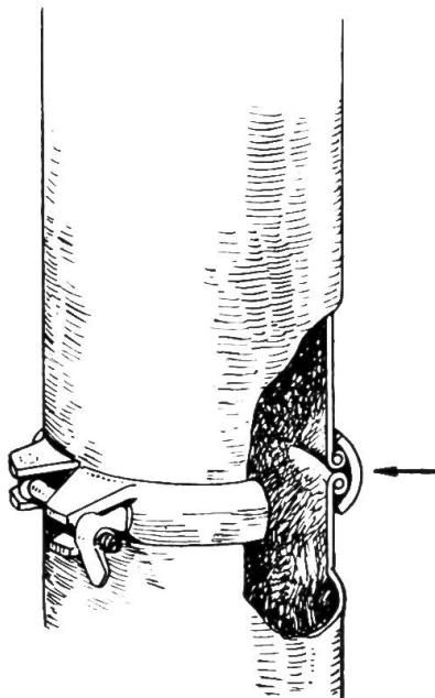
Verbeulte Rohre ausrichten !
