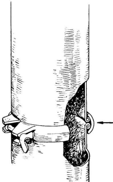
Verbeulte Rohre ausrichten !
