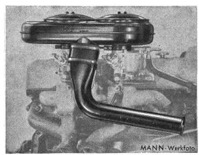
Dämpfer-Filter in einem PKW-Motor
