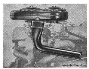
Dämpfer-Filter in einem PKW-Motor
